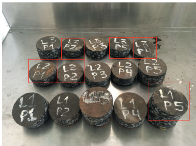
Figura 07 - Visão geral dos corpos de prova extraídos para ensaio de RT
