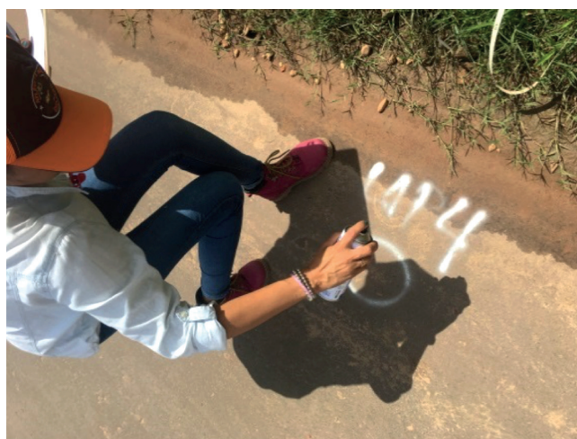
Figura 03 – Marcação dos pontos de extração de CPs
