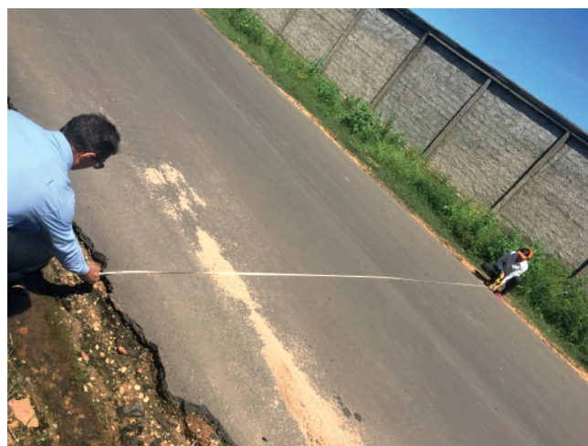
Figura 02 – Aferição da seção transversal
